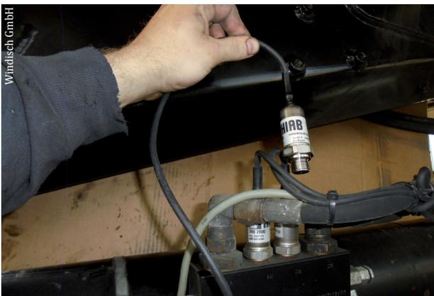
Erneuerung eines defekten Drucksensors nach Diagnose des Mangels am Ladekran
