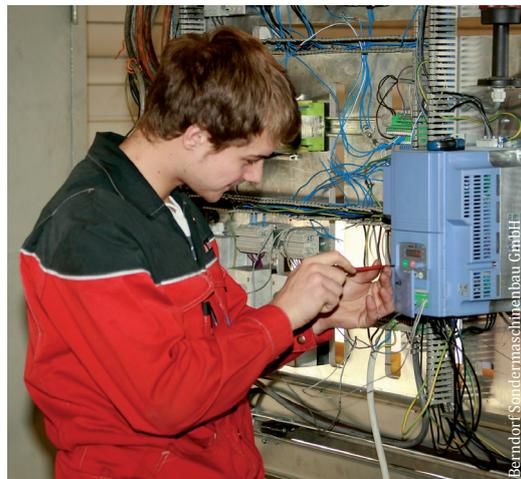
Verdrahtungsarbeiten an der Übungstafel
