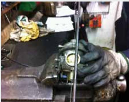
Der Vergaser wird zerschnitten,
